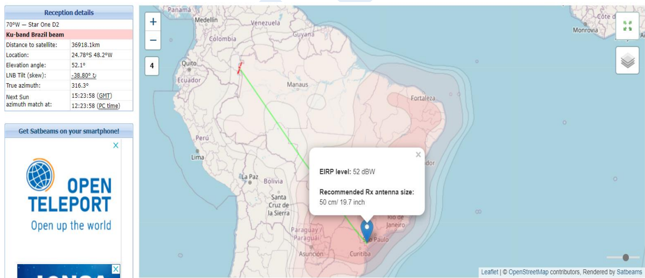
Figura 6- Exemplo de resultados de cálculo para definição do tamanho das antenas, disponível na internet.
