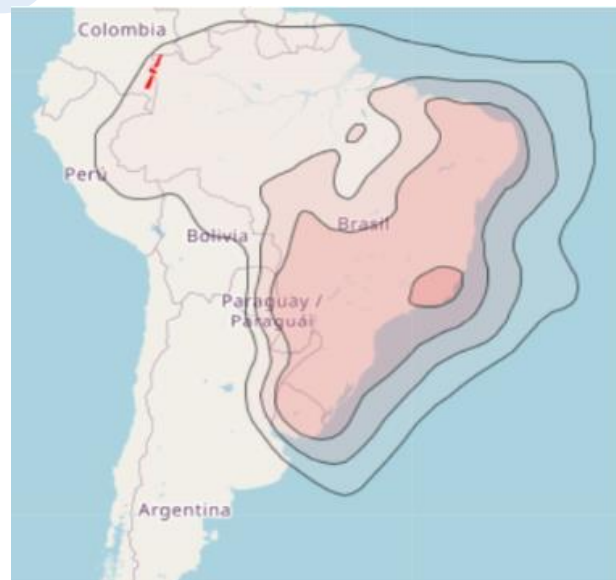
Figura 2 – Exemplo de iluminação do território brasileiro por um satélite em banda Ku (footprints). As cores mais escuras indicam maior nível de sinal.
